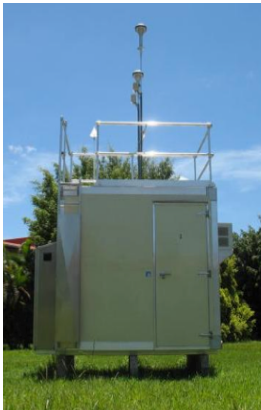
Fotografía 1. Estación de monitoreo automático de Calidad del Aire
